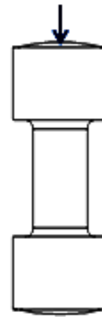
图6 柱式称重传感器弹性体示意图
